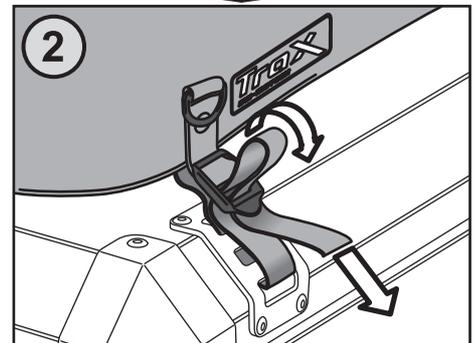
Die Überlänge der Befestigungsgurte kann abgeschnitten werden. Achten Sie darauf, das Endstück mit einem Feuerzeug zu versiegeln.
