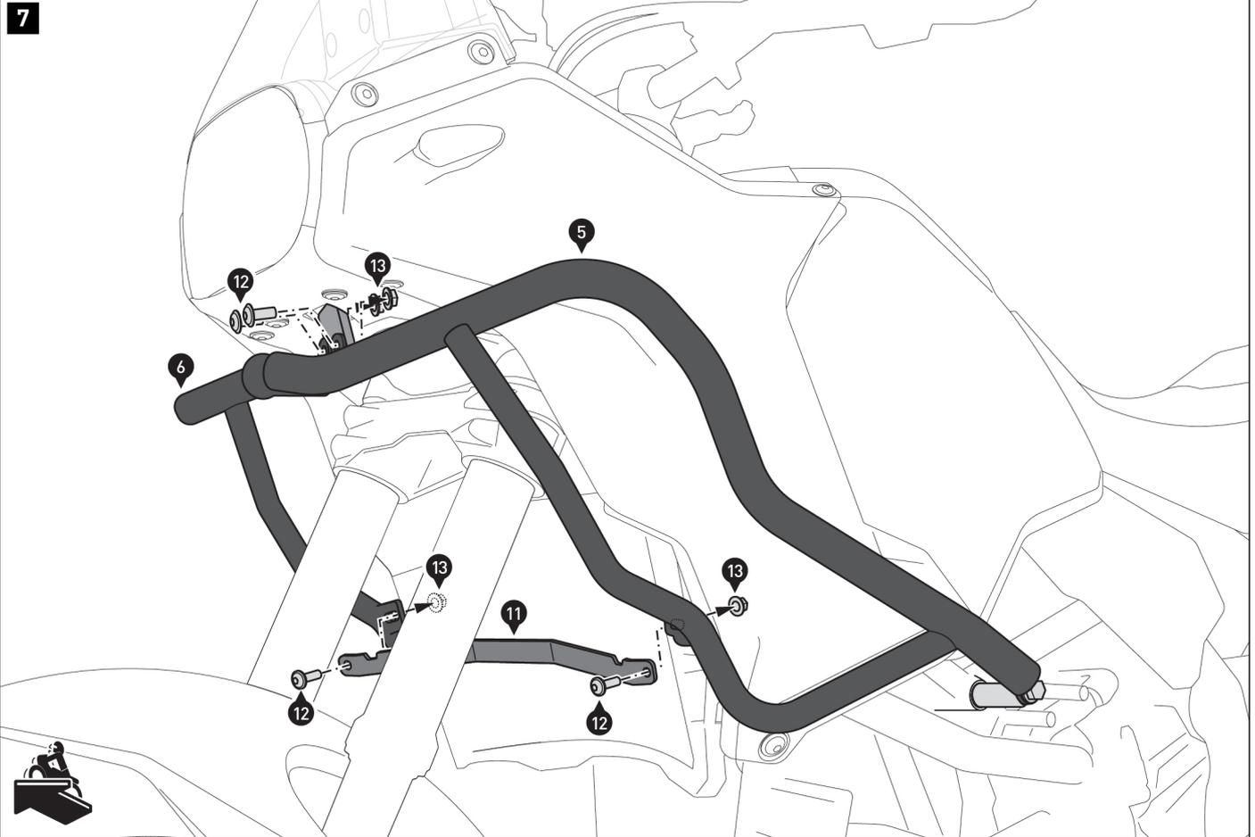
Verschrauben Sie die Sturzbügelhälften (5) und (6) am Anbaublech (1).
