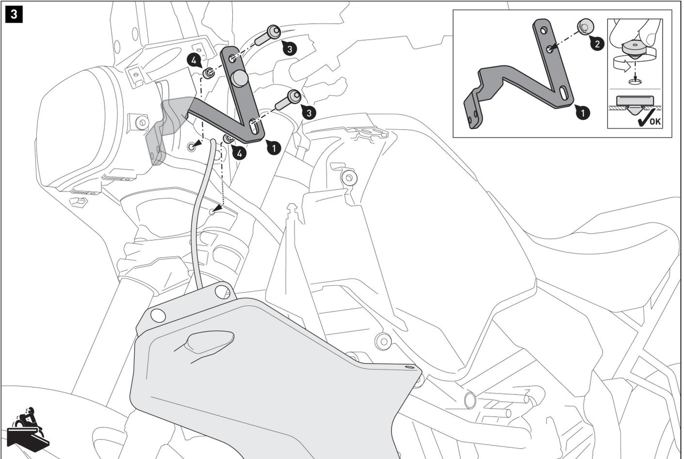
Setzen Sie den Vibrationsdämpfer [2] in die Öffnung des Anbaublechs (1) ein, wie in der Detailzeichnung gezeigt.
