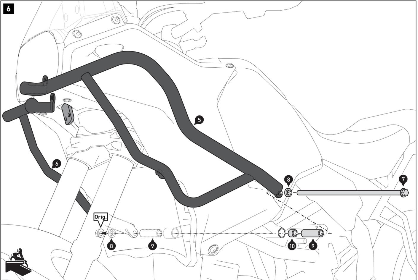
Verschrauben Sie die Sturzbügelhälften (5) und (6) am Fahrzeug.
