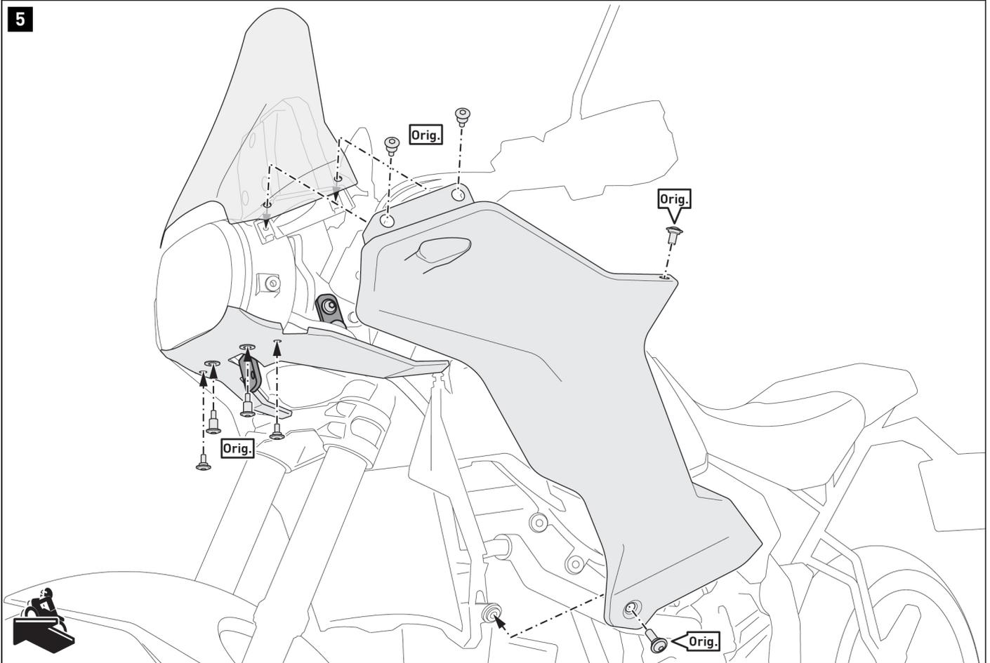
Bringen Sie die zuvor demontierten Verkleidungsteile wieder am Fahrzeug an.
