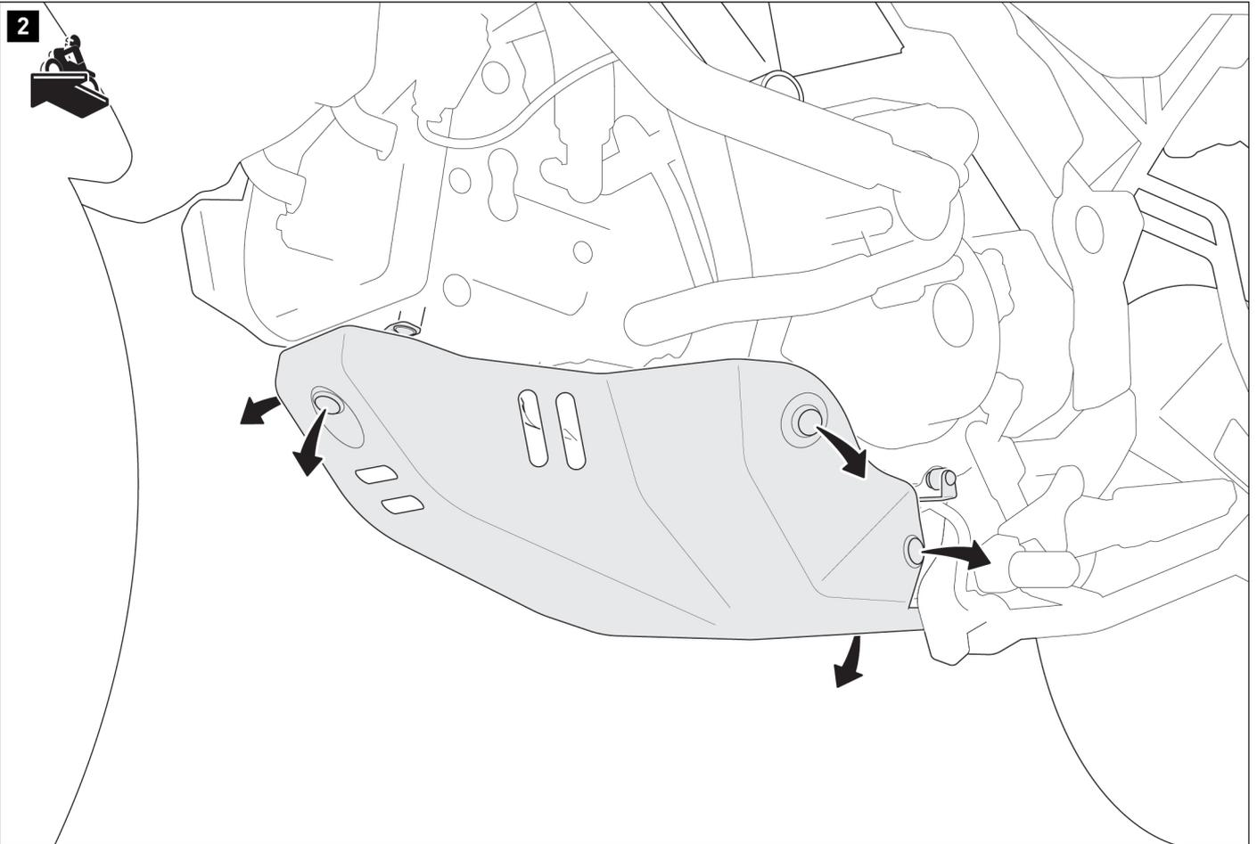
Lösen Sie die gezeigten Schrauben des original Motorschutzes.
