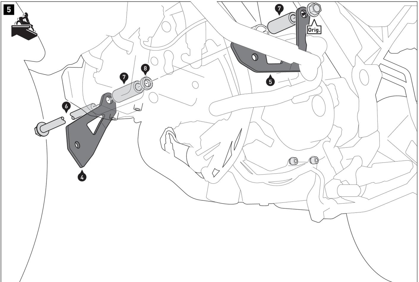
**⚠ HINWEIS:** Verwenden Sie bei gleichzeitiger Montage mit dem SW-MOTECH Sturzbügel die gezeigten Teile. Die Sturzbügel werden auf den Anbaublechen (4) und (5) verschraubt.
