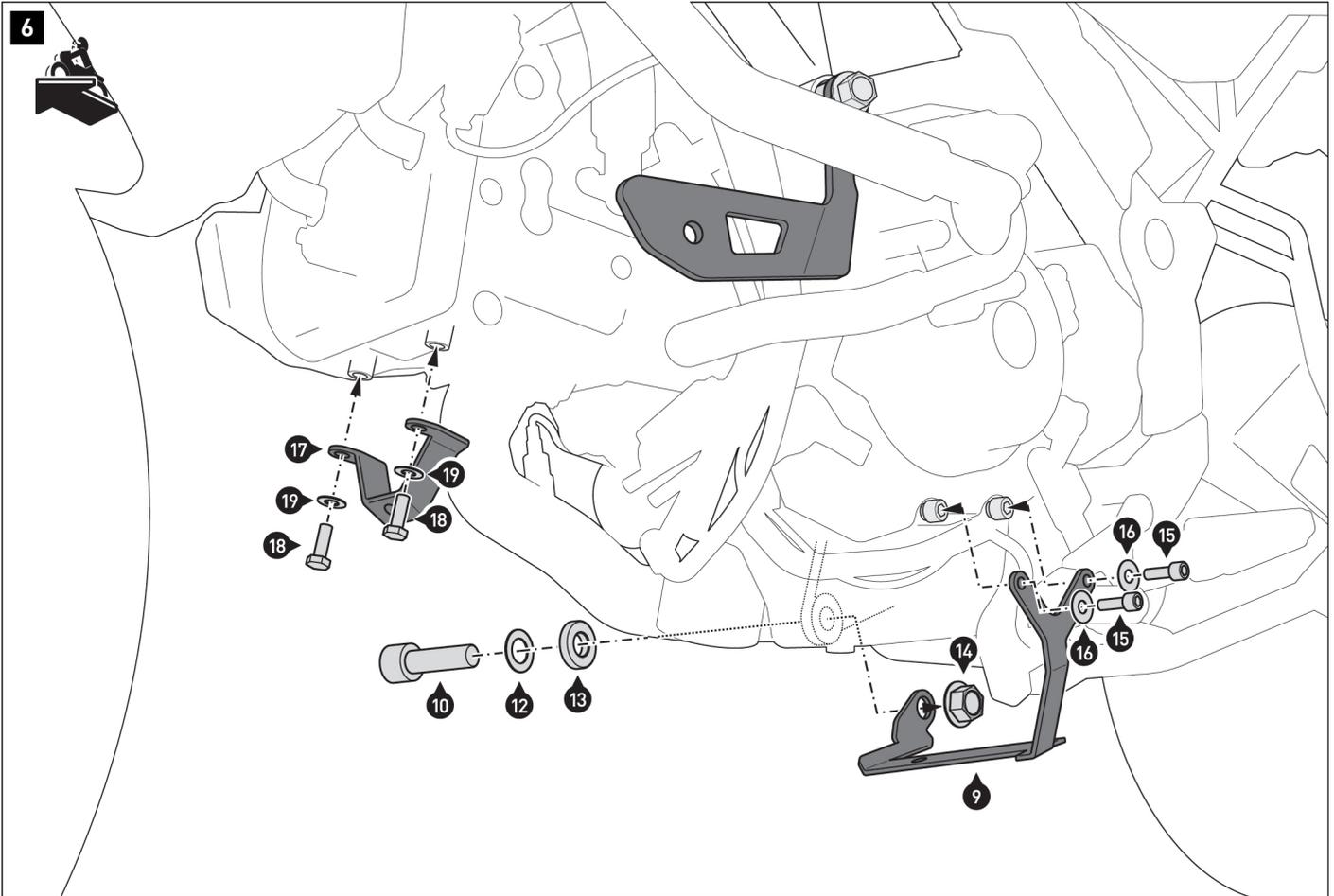
**⚠ HINWEIS:** Verwenden Sie bei gleichzeitiger Montage mit dem SW-MOTECH Hauptständer die Schraube (11) am linken Anbaupunkt. Die Teile (12) und (13) entfallen. Verwenden Sie stattdessen die Teile des Hauptständers.
