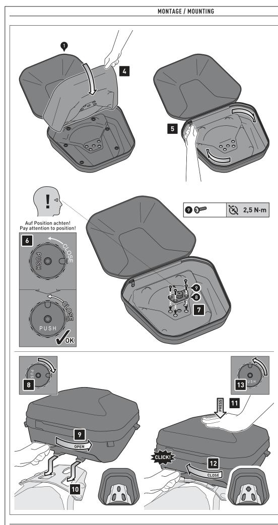
Schritt [4]: Klappen Sie die Innenverkleidung nach unten.
