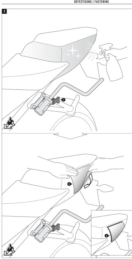
DE - Nachdem Sie die Abstandsbügel an Ihrem Fahrzeug montiert haben, müssen Sie die Auflageflächen der Satteltaschen mit der beigepackten Lackschutzfolie (2) bekleben, um Beschädigungen zu vermeiden. Reinigen Sie die zu beklebende Fläche vor dem Aufbringen der Lackschutzfolie gründlich von Fett- und Schmutzrückständen. ACHTUNG: Scharfkantige Ecken
