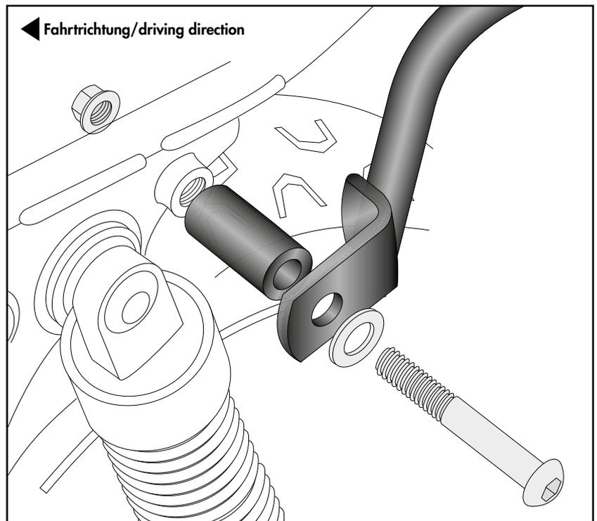
Die Distanz wird auf der linken Seite bei gemeinsamer Montage mit dem C-Bow Halter durch die Stahldistanz Ø16xØ9x25 ersetzt.
