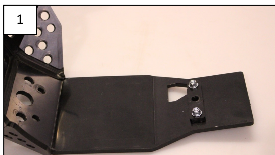
1 Fit the rear plastic part Fixer la pièce plastique arrière
