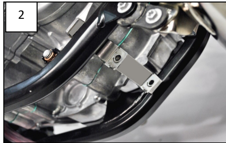
2 Installer la bride avant Fit the front bracket
