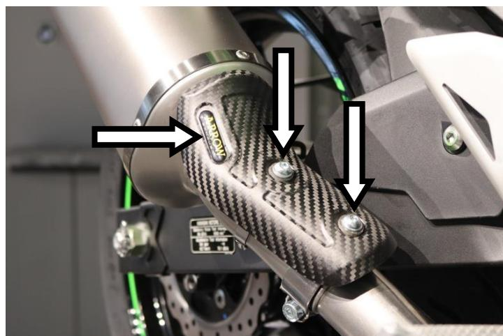
**IT** · Montare ed adesivare la protezione
