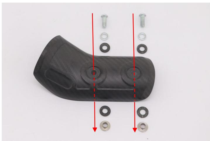
**IT** · Schema di montaggio protezione
