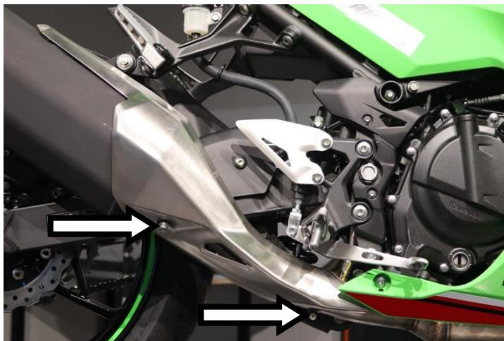
**IT** · Svitare la fascetta, la vite di fissaggio e rimuovere la protezione dal terminale
