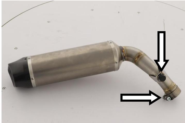
**IT** · Inserire il gommino nel foro dell'attacco e posizionare la fascetta nell'innesto del terminale
