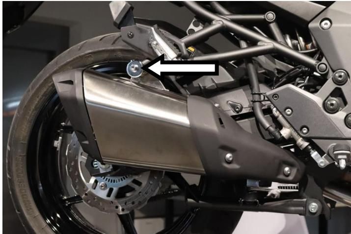
**IT** · Innestare il terminale originale comprensivo di guarnizione e serrare l'attacco
