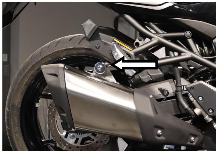
**IT** · Svitare la vite di fissaggio e rimuovere il terminale
