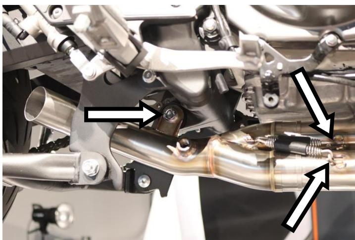
**IT** · Innestare il raggruppamento 2:1, serrare senza stringere completamente l'attacco al telaio ed ancorare le due molle
