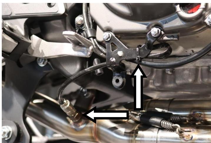
**IT** · Avvitare la lambda e fissare il cavo alla staffa mediante fascetta a strappo fornita
