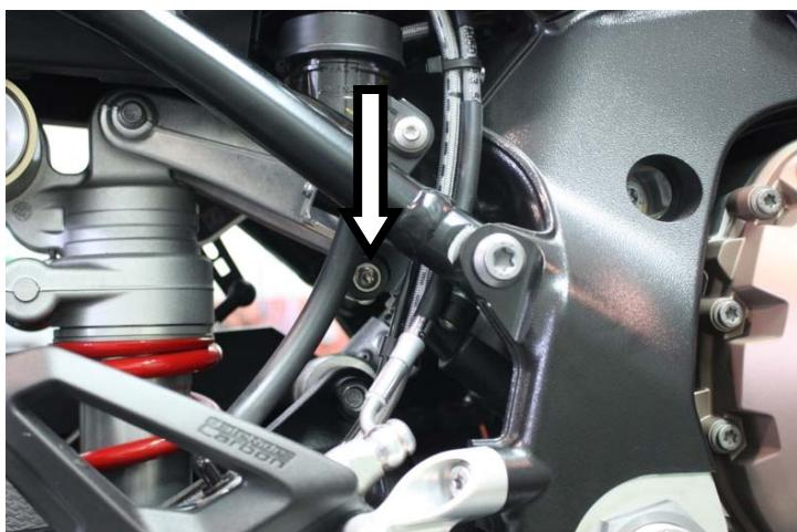
**IT** · Svitare la vite indicata e sfilare il motore attuatore valvola
